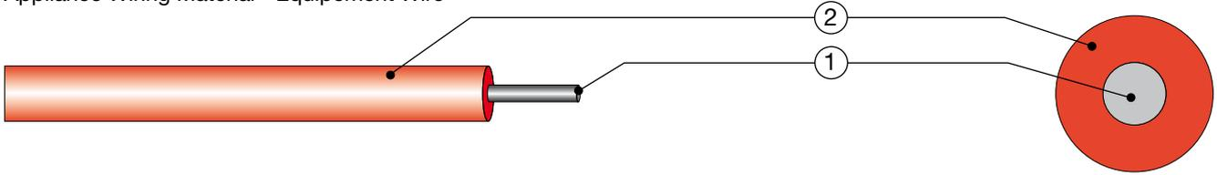
Diese Verdrahtungslitzen sind UL und CSA approbiert und werden zur Verdrahtung von Schaltschränken sowie zur Installation in Schutzschläuchen des Maschinenbaus benötigt, die im Geltungsbereich der nordamerikanischen Normen eingesetzt werden.
