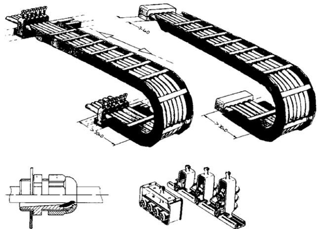
7. Veiller à ce que les câbles puissent se déplacer librement dans le rayon de courbure de la chaîne, il ne doit pas y avoir de guidage forcé par la chaîne afin de permettre un mouvement relatif des câbles entre eux et par rapport à la chaîne. Il est recommandé de contrôler la position du câble après un certain temps de fonctionnement. Ce contrôle doit se faire après des mouvements de poussée et de traction.
