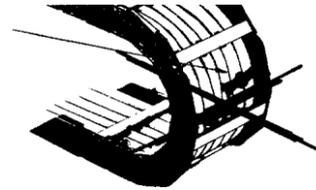
6. La fixation des câbles doit se faire aux deux extrémités de la chaîne. Sur les longues chaînes où le brin supérieur passe sur le brin inférieur, les câbles ne sont fixés qu'à l'extrémité motrice.
